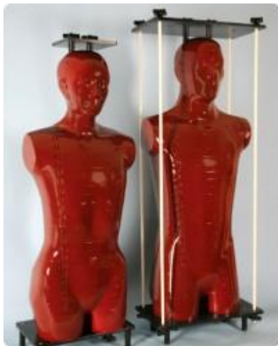
شکل ۱۰- قرص TLD ساخت شرکت ایمن گستر رامن گیش به همراه فانتوم برای جایگذاری قرص ها برای مقاصد تحقیقاتی پزشکی
