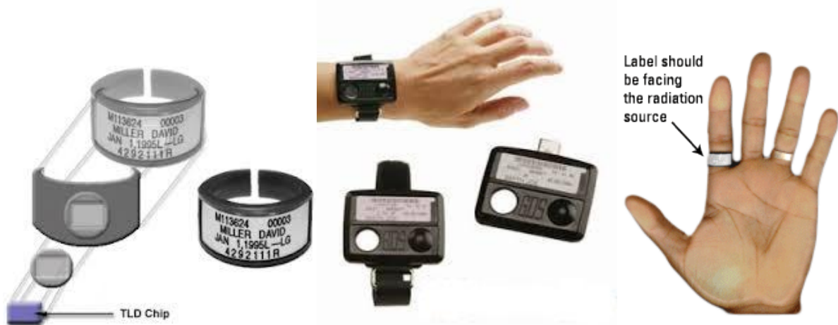
شکل ۸- انواع مختلفی از کارت و قرص درون بیج انگشتی و مچی برای افراد پرتو کار
